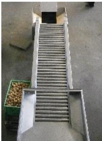
Роликовый инспекционный стол предназначен для контроля качества выпускаемой в торговую сеть продукции. Контроль качества продукции производится путем ручной выбраковки не кондиции. Инспекционные столы могут быть оснащены дополнительным оборудованием: освещением, вариатором скорости, желобом для отвода брака, разделителем и направляющими потоков.
