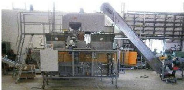
Весовая станция предназначена для взвешивания картофеля и овощей. Машина отличается точностью взвешивания при высокой производительности. Взвешивание продукции происходит в 10 взвешивающих чашках. Весовую станцию можно комбинировать с любыми упаковочными машинами. Конструктивная особенность машины позволяет агрегатировать её с 3 упаковщиками.
