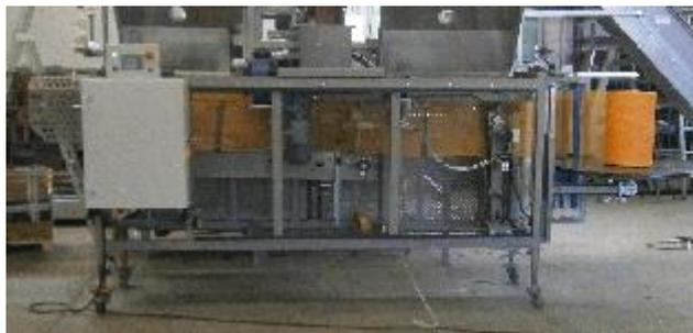
В полной комплектации машина предназначена для упаковки картофеля, моркови и других овощей в сетку-мешок от 2,5 до 25 кг. Закрытие сетки-мешка происходит путём зашивки горловины. Конструкция машины позволяет легко и быстро проводить необходимое техническое обслуживание. При необходимости, нанесение информации на упаковку возможно с помощью принтера (дополнительное оборудование).
